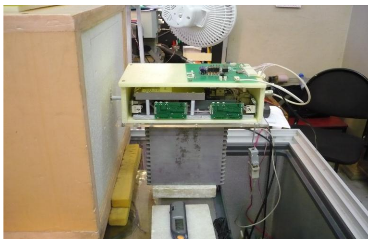
Рис.3. Стенд контроля выходных характеристик МКВ-радиометров
