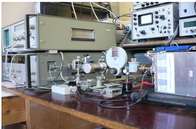
Рис.4. Стенд контроля амплитудно-частотных характеристик МКВ-радиометров
