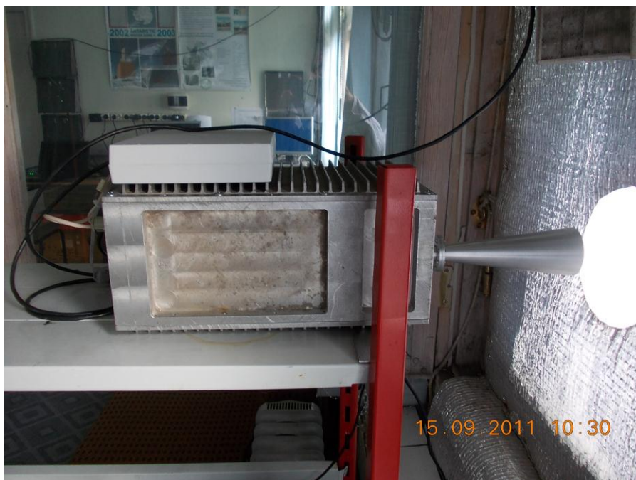
Рис.5. Натурные испытания макета 5 мм спектрометра по реальной атмосфере
