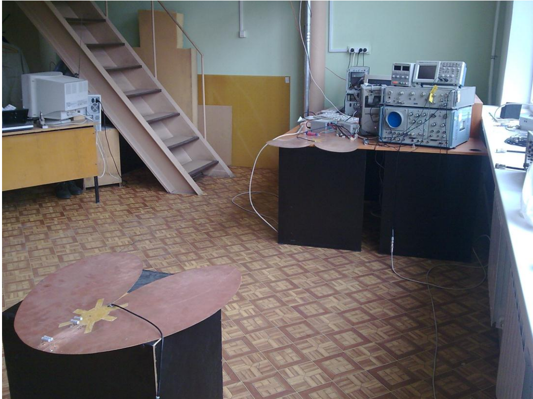
Рис.6. Исследование приемопередачи импульсного сигнала антеннами линейной поляризации
