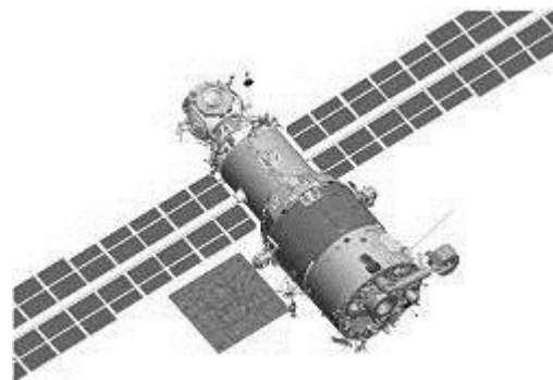
Рис.5. Схема МКС с предполагаемым вариантом расположением антенны.
