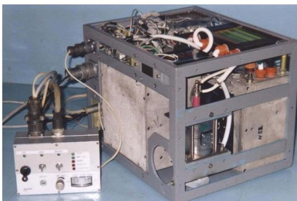
**Рис. 3. Компоновка высоковольтного источника питания.**
