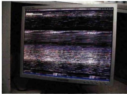
Рис 5. Пример сбоя видеосистемы ПК во время воздействия ЭМИ.
