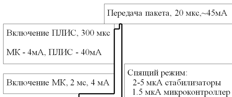
Рис 5. Цикл работы радиометки
