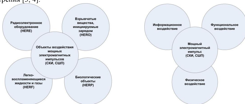
Рис. 1. Объекты воздействия мощных преднамеренных электромагнитных факторов и электромагнитные эффекты, возникающие при электромагнитном воздействии на радиоэлектронные средства
