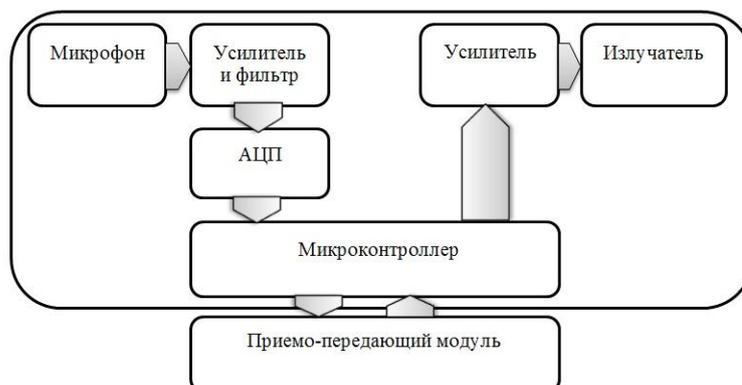
Рис.1. Структурная схема акустического модуля
