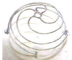
Рис. 2б. Изогнутая сферическая спиральная антенна
