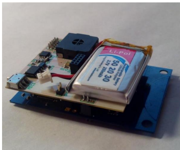
Рис. 3. Акустический модуль (сверху) подключен к приемопередающему узлу беспроводной сенсорной сети.
