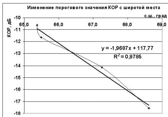
Рис. 6. Изменение \sigma_{\text{порог}}^0 с широтой места.
