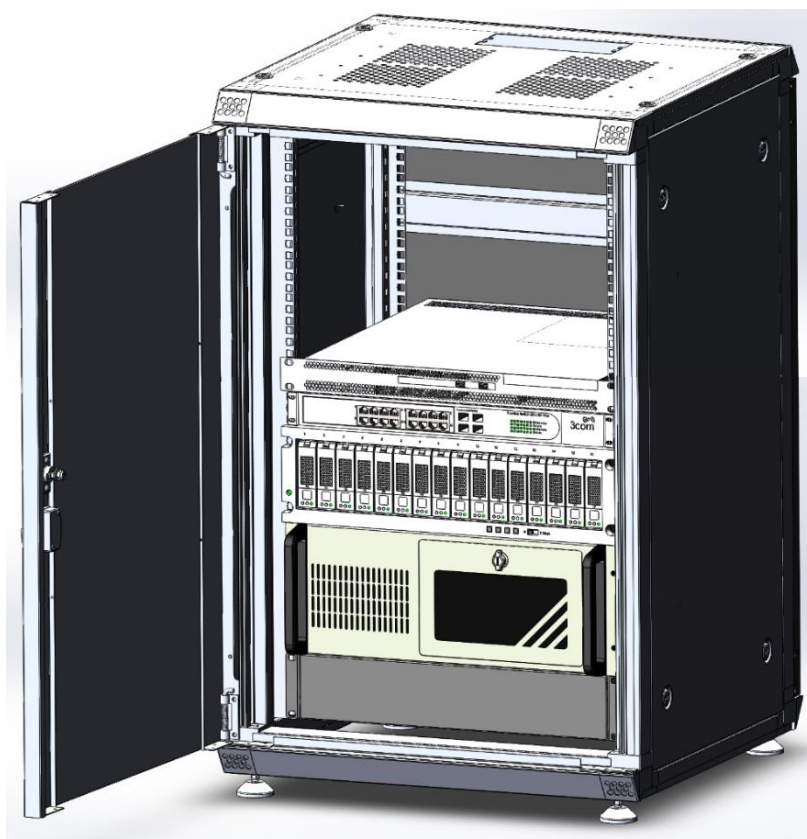
Рис. 3. Трёхмерная модель размещения аппаратуры в стойке.
