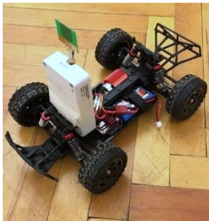
Рис. 8. Мобильная колёсная платформа с ПИМ-57.
