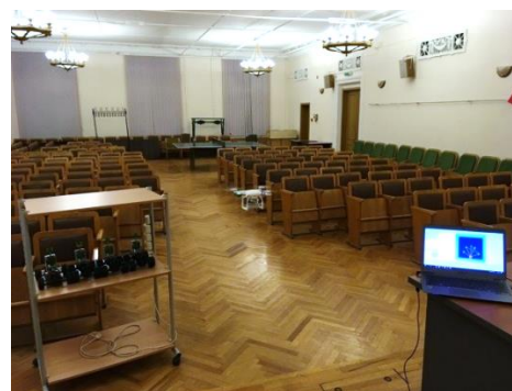
Рис. 10. Мобильная группировка, включающая четыре колесных платформы и квадрокоптер: а) группировка перед стартом квадрокоптера, топология коммуникационной сети полносвязна; б) квадрокоптер летает по залу, топология сети меняется с изменением положения БПЛА.
