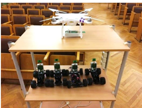
Рис. 10. Мобильная группировка, включающая четыре колесных платформы и квадрокоптер: а) группировка перед стартом квадрокоптера, топология коммуникационной сети полносвязна; б) квадрокоптер летает по залу, топология сети меняется с изменением положения БПЛА.
