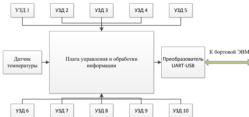
Рис. 3. Структурная схема системы ультразвуковой локации.
