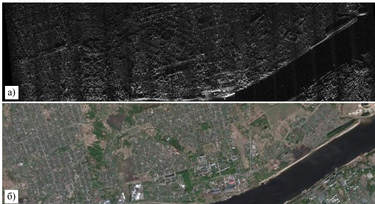
Рис. 9. Результирующее РЛИ с разрешением 1,9 м (а) и спутниковый фотоснимок (б) городской местности (полосовой обзор).
