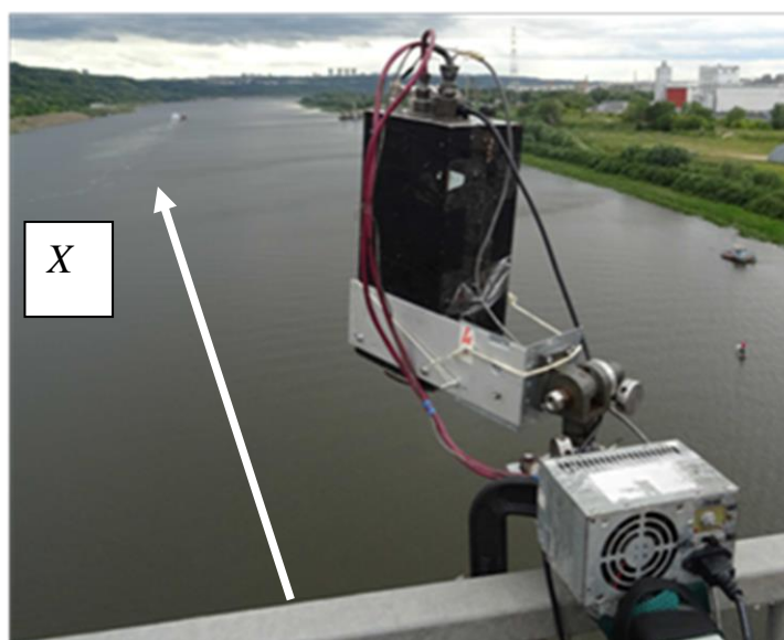
Рис. 3. Доплеровский радиолокатор (9,7 мм) во время эксперимента на мосту.
