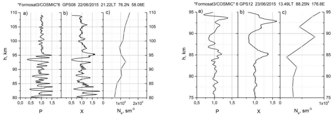
**Рис. 4.** Высотные зависимости нормированной мощности –  $P(h)$ , рефракционного ослабления –  $X(h)$  и электронной концентрации –  $N_e(h)$ , полученные по радиозатменным данным FORMOSAT-3/COSMIC 22.06.2015 в 21.22LT в районе с координатами 76.2°N; 58.08°E (слева) и 23.06.2015 в 13.49LT в районе с координатами 88.25°N; 176.6°E (справа)
