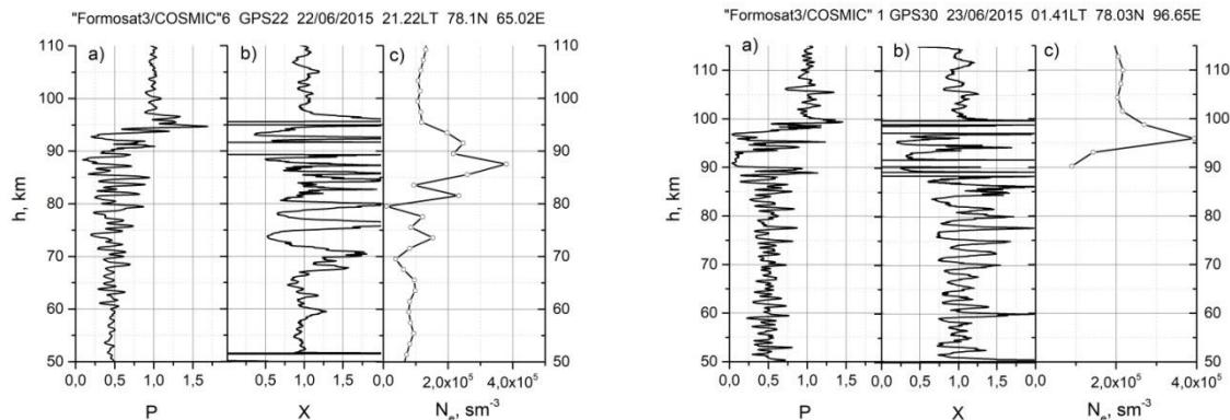
**Рис. 5.** Высотные зависимости нормированной мощности –  $P(h)$ , рефракционного ослабления –  $X(h)$  и электронной концентрации –  $N_e(h)$ , полученные по радиозатменным данным FORMOSAT-3/COSMIC 22.06.2015 в 21.22 LT в районе с координатами 78.1°N; 65.02°E (слева) и 23.06.2015 в 01.41LT в районе с координатами 78.03°N; 96.65°E (справа)
