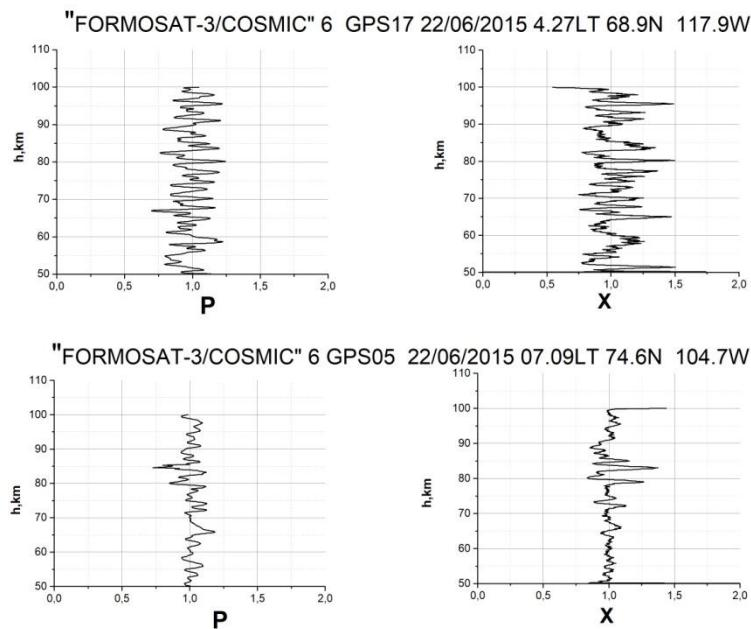
**Рис. 3. Высотные профили нормированной мощности ( $P$ ) сигнала, измеренной накануне геомагнитной бури 22 июня 2015 года на спутнике FORMOSAT-3/COSMIC, и рефракционного ослабления ( $X$ ) радиоволн, восстановленного из измерений эйконала**
