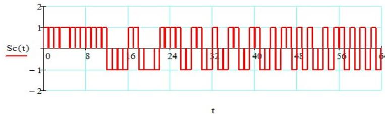
**Рис.16 ШПС из последовательности  $M=8$  пакетов опорных ЭПСС  $N=8$  порядка**
