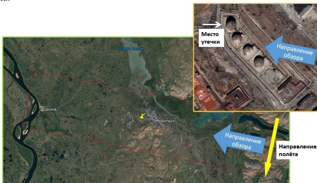
Рис. 1. Снимок территории ТЭЦ-3 и геометрия съемки РСА Sentinel-1 на нисходящем витке
