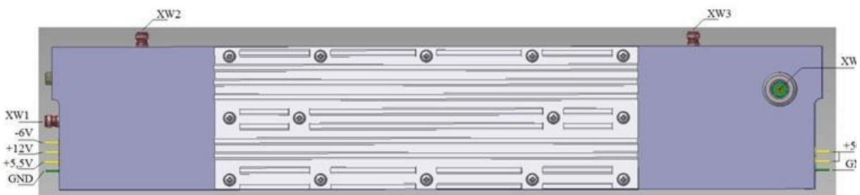
Рис. 3. Конструкция мощного оконечного усилителя L-диапазона из состава макета двухчастотной РЛС высокого разрешения с синтезированной апертурой для дистанционного зондирования Земли: а) вид сверху(крышка снята); б) вид снизу.
