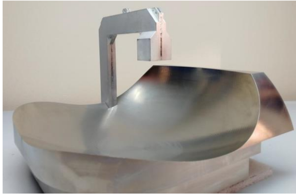
Рис. 2. Антенна с формой диаграммы направленности с косеканс-квадрат: а) внешний вид б) характеристики направленности в вертикальной плоскости (справа).
