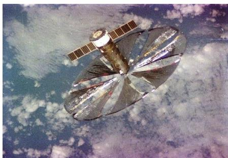
Рис. 3. Космический аппарат «Прогресс М-15» с развернутым солнечным парусом.
