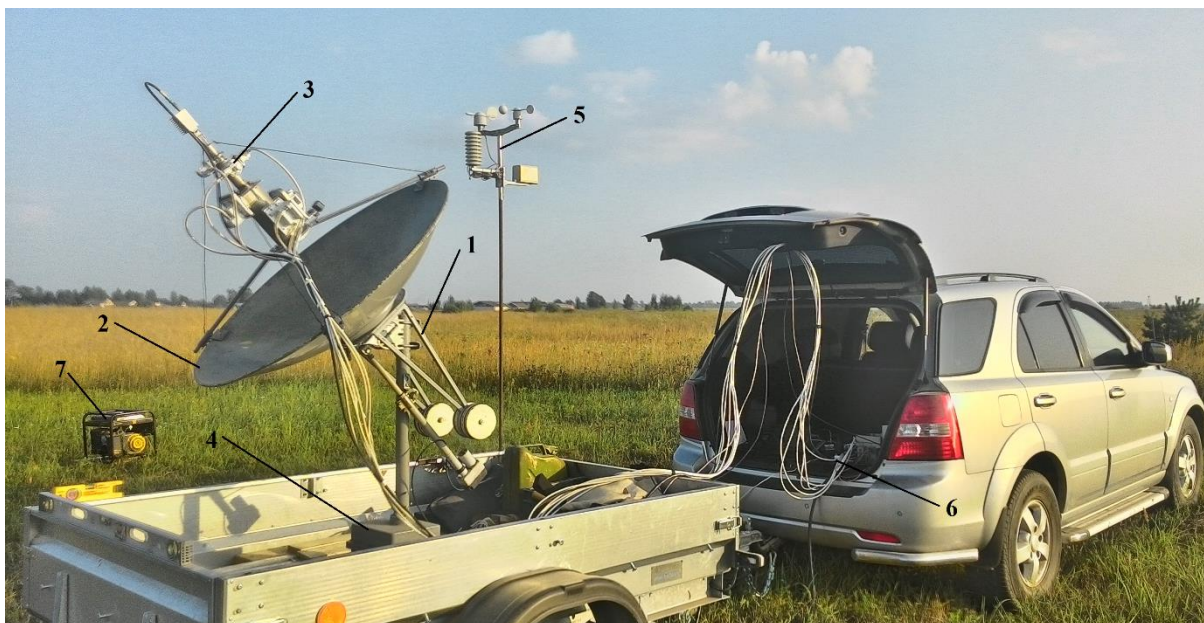
1 – Антенная колонка; 2 – Антенна; 3 – Радиометрическая система; 4 – Поворотное устройство; 5 – Метеостанция; 6 – Элементы блоков управления и обработки информации; 7 - Электродгенератор Рис. 11. Мобильный вариант системы
