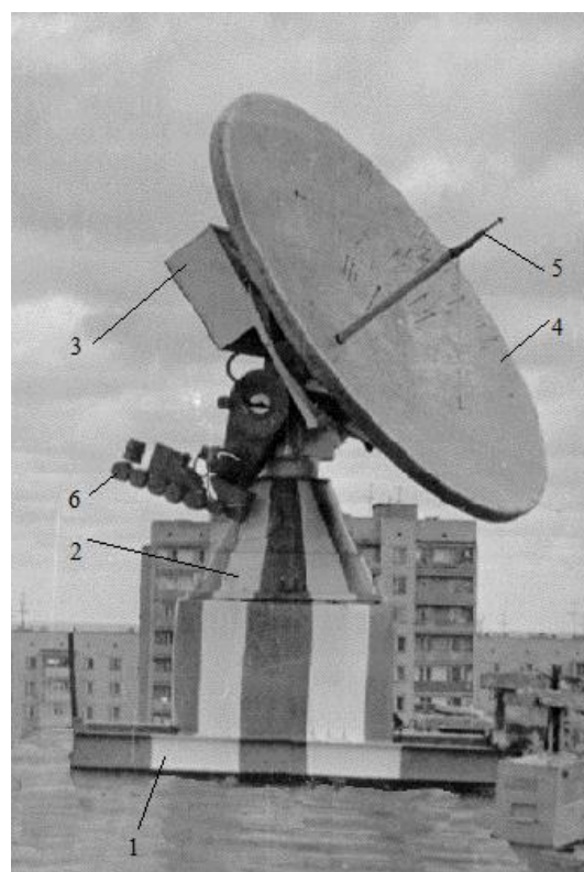
1 – несущая рама; 2 – антенная колонка; 3 – место размещения АК и ПК; 4 – параболический отражатель; 5 – облучатель; 6 - противовес.
