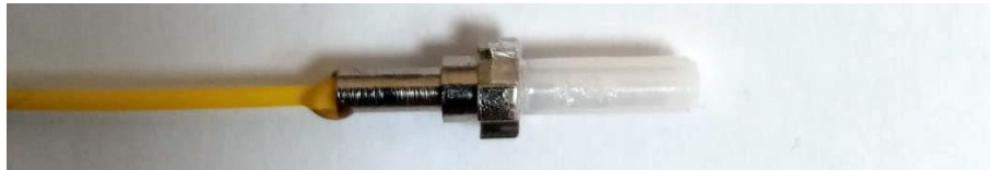
Рис. 2. Лабораторный образец резонатора Фабри-Перо
