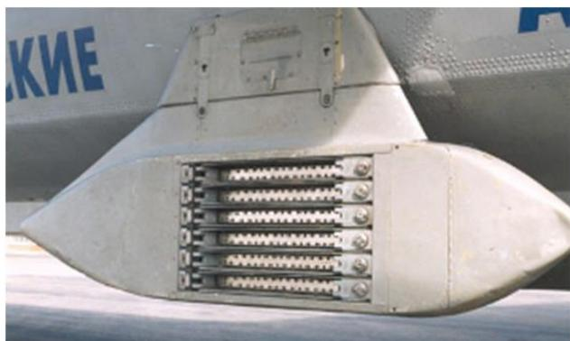
**Рис. 4 Устройство для отстрела пиропатронов-генераторов**
