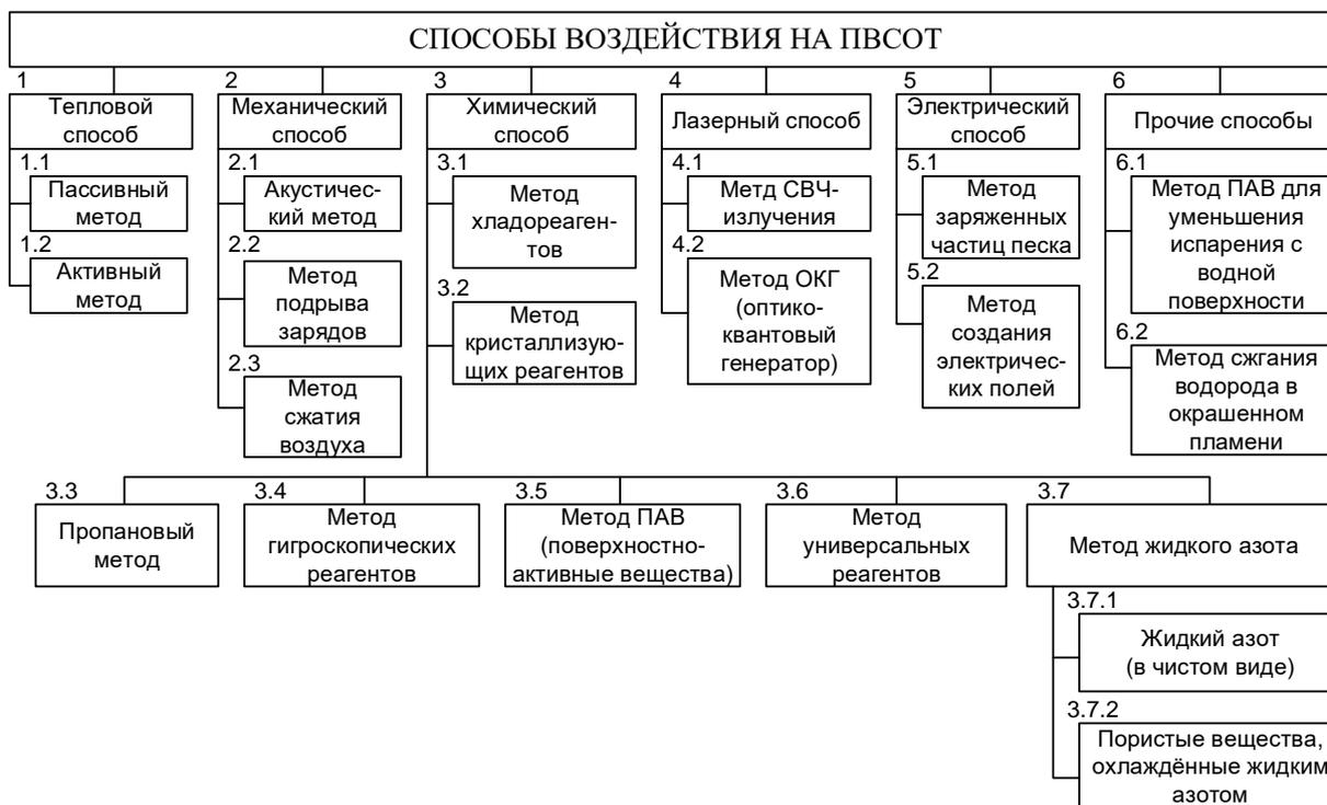
**Рис. 1. Способы и методы воздействия на переохлажденные волнистообразные и слоистообразные облака и туманы (ПВСОТ)**
