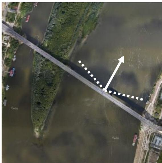
**Рис. 1. Схема эксперимента. Белыми пунктирными линиями показаны ограничения азимутального поворота радиолокатора. Белой стрелкой - направление зондирования.**
