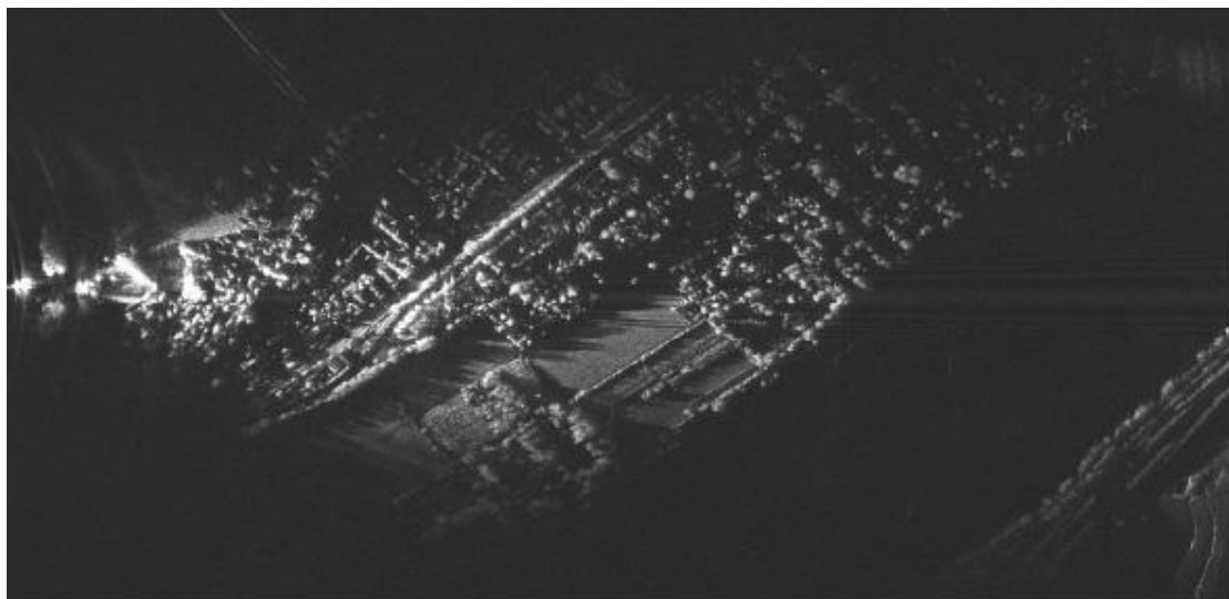
Рис. 7. Самолётное/стационарное бистатическое радиолокационное изображение
