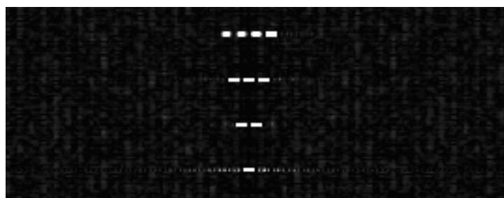
Рис. 5. Расположение точечных целей в четвёртой зоне неоднозначности
