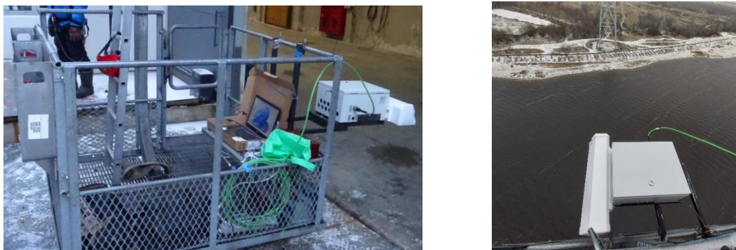
Рис. 2. Технологическая тележка с установленным радиолокатором перед измерениями (слева) и во время эксперимента при движении над водной поверхностью (справа).
