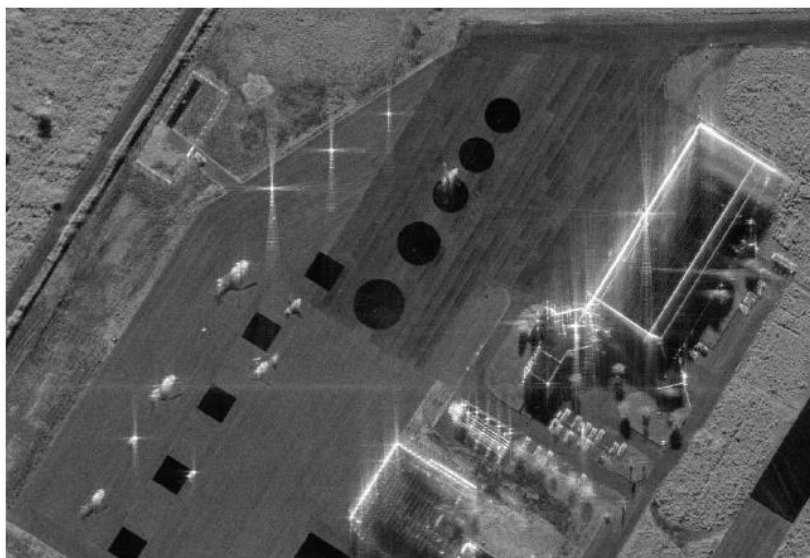
Рис. 1. Вид радиолокационного изображения (РЛИ) вертолетной площадки с разрешением около 10 сантиметров
