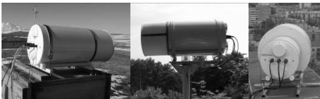
Рис.2. Примеры одноканальных микроволновых температурных профиломеров МТР5
