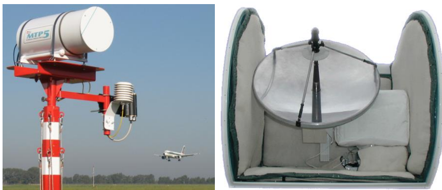
Рис.3. Варианты микроволновых профиломеров-для средних широт (слева) и первая полярная версия (справа).
