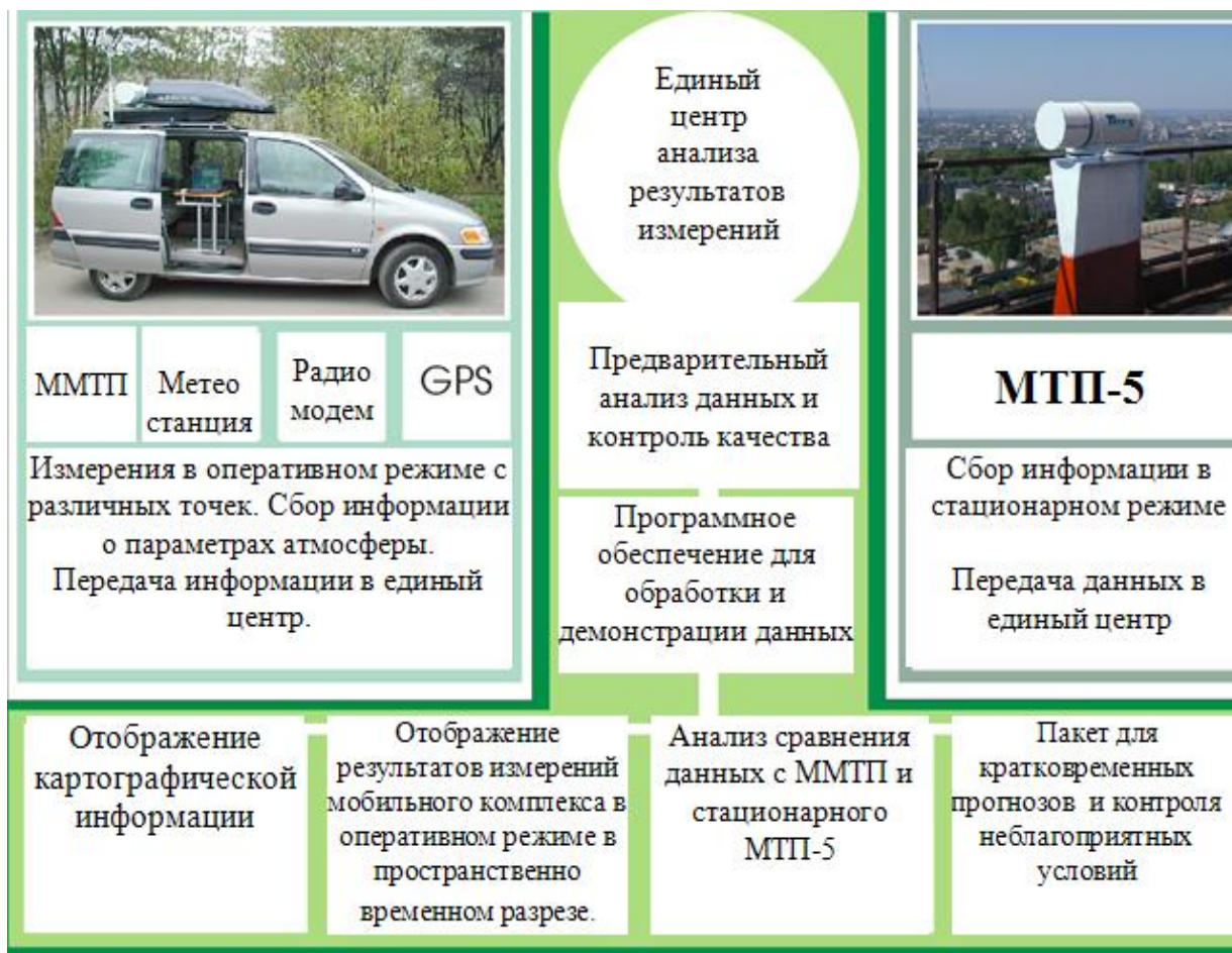
Рис. 6. Структурная схема микроволновой системы ЦАО для мониторинга термического режима АПС.
