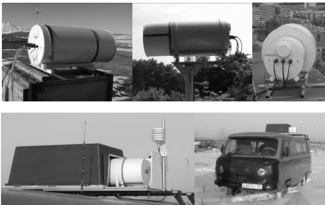
Рис.4. Различные варианты микроволновых температурных профиломеров АПС.
