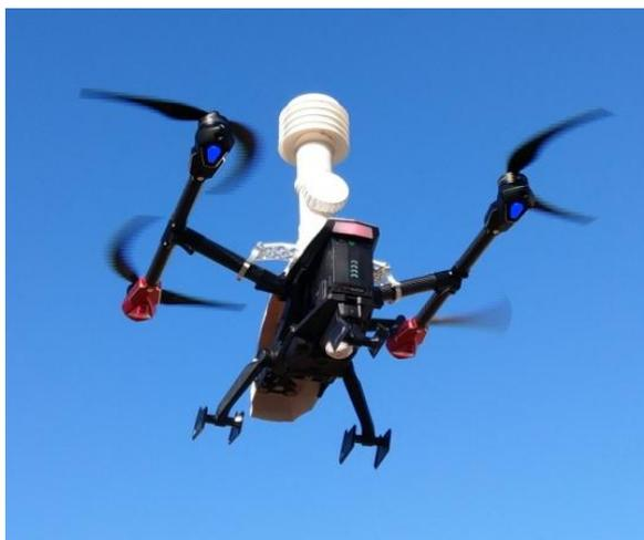
**Рис. 3. Макет беспилотного метеоизмерителя на базе квадрокоптера Walkera Voyager 3 в полете**
