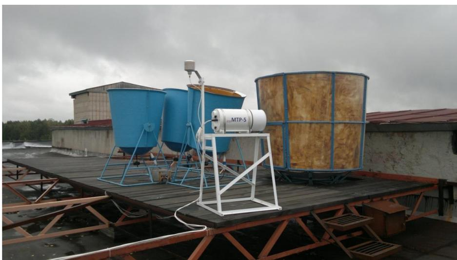
**Рис. 1. На переднем плане профилемер МТР-5 и акустические локаторы, установленные на крыше ИМКЭС СО РАН, г.Томск**
