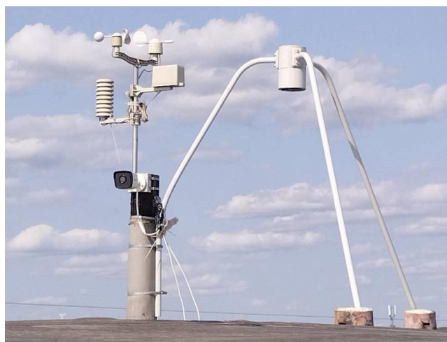
Рис. 5.1 Измеритель напряженности электрического поля атмосферы
