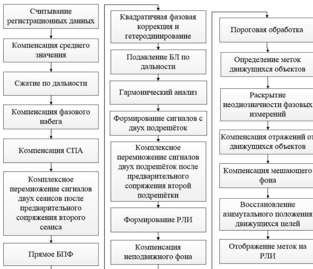
Рис. 4. Блок-схема основных этапов цифровой обработки радиолокационных сигналов
