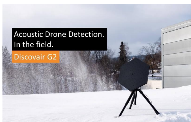
Рис.4. Акустическая система обнаружения дронов Discovair
