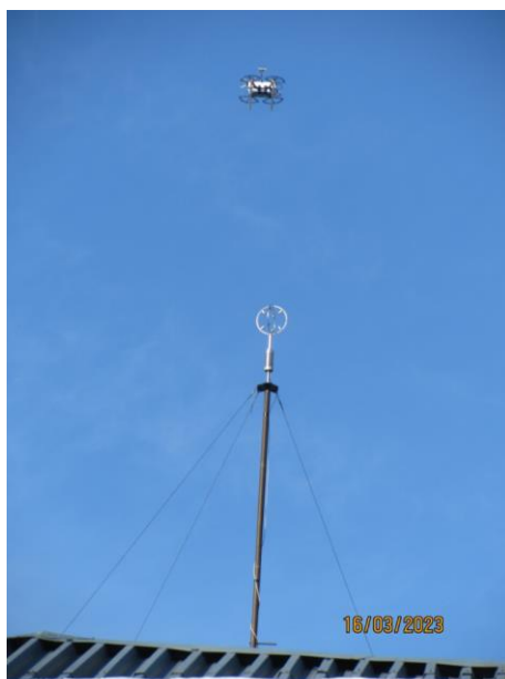
Рис. 7. Квадрокоптер KSA-1 над ультразвуковой метеостанцией
