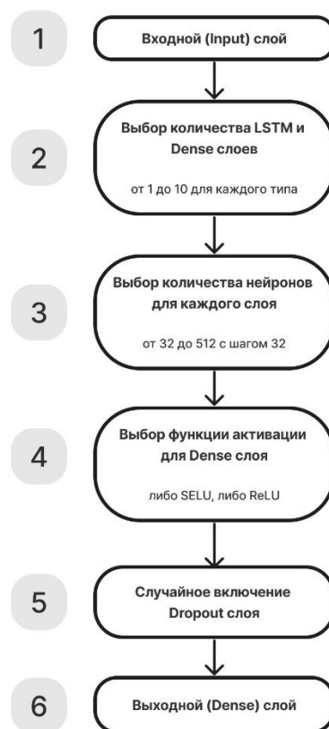
Рис. 3. Алгоритм синтеза структуры и подбора гиперпараметров нейронной сети
