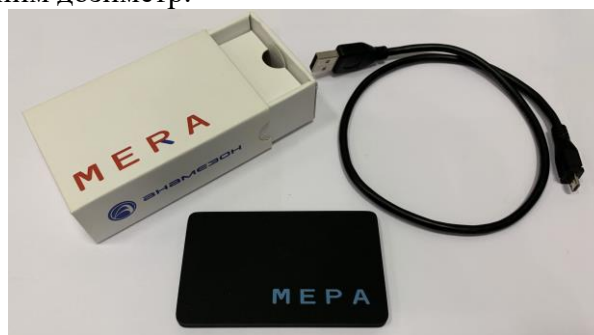
а) б) Рис. 2. а) Спектр мощности передатчика, б) Внешний вид дозиметра электромагнитного излучения МЕРА
