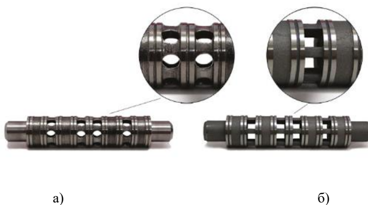
а) б) Рис. 2 Золотник гидрораспределителя выполнен: а) по традиционной технологии; б) с помощью SLM технологии
