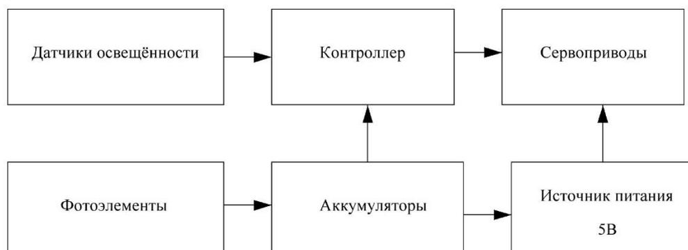
Рис. 1 - Структурная схема устройства
