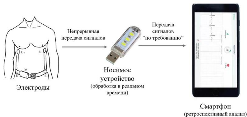
Рис. 1. Принципиальная схема системы непрерывного мониторинга биосигналов
