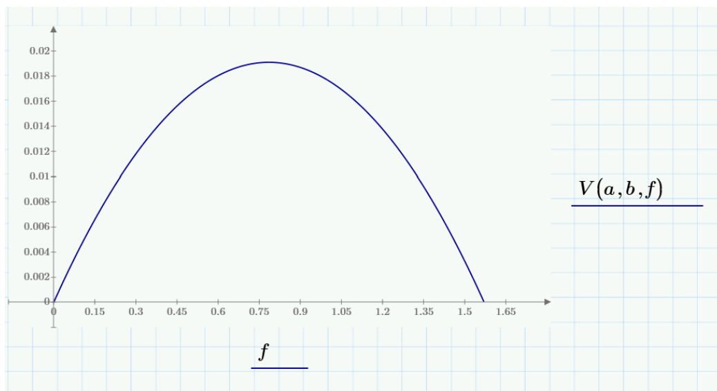
Рис. 4. График зависимости аналога скорости толкателя V от угла поворота кулачка \varphi
