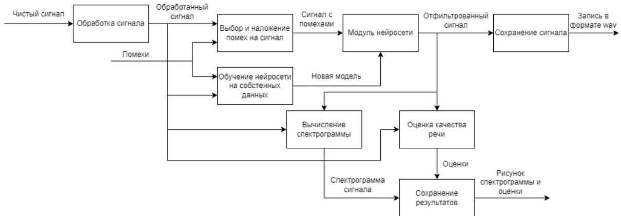
Рис. 1 – Функциональная схема системы для исследования модели обработки сигнала.
