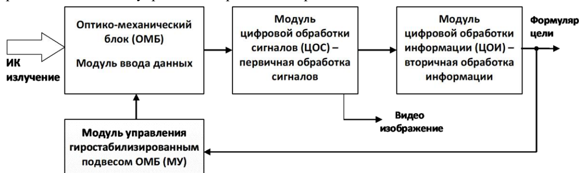
Рис.1 – Структура макета оптоэлектронного устройства слежения за целью.
