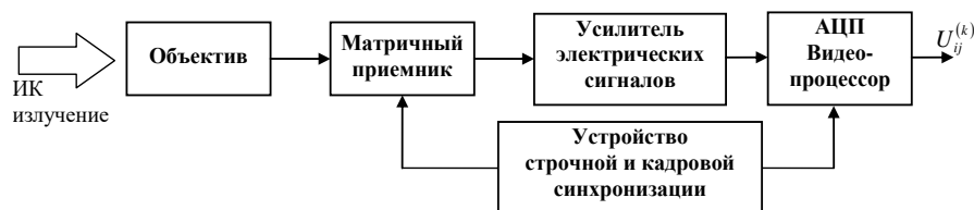
Рис. 1. Структурная схема формирования изображения ОЭС
