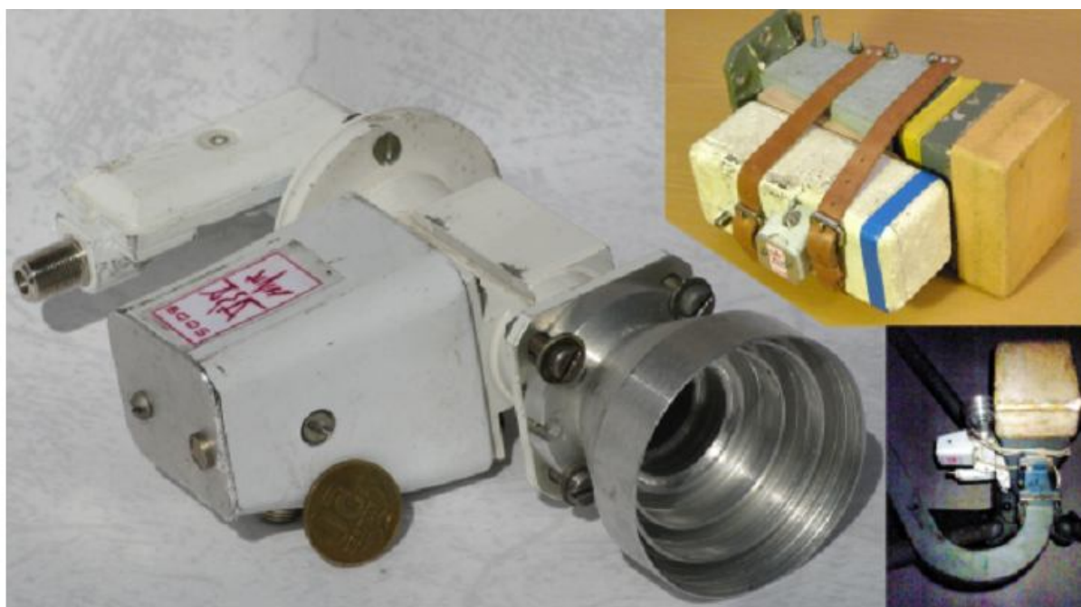
Рис. 2. Макет СВЧ радиометра пассивного канала на облучателе МРЛ-5
